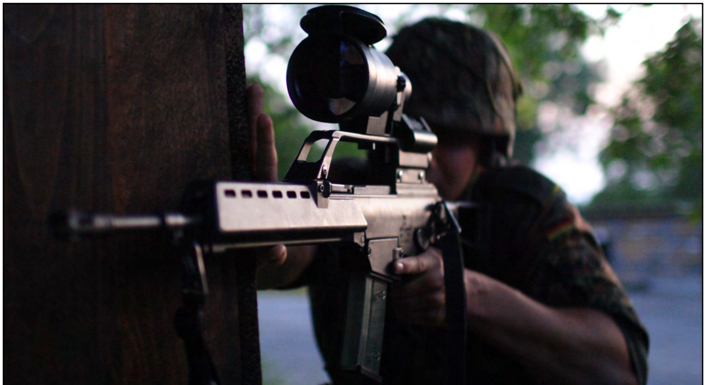
Ermöglicht den Feuerkampf bei Nacht: der Nachtsichtaufsatz 80 (NSA 80) montiert auf dem G36.
